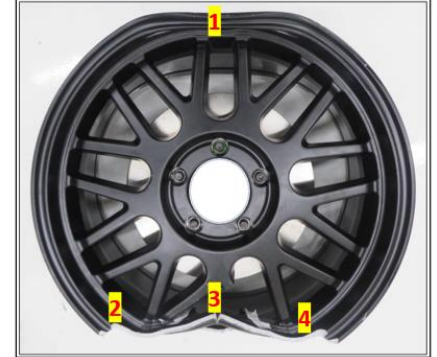
Fig.9: Actual Failure image
